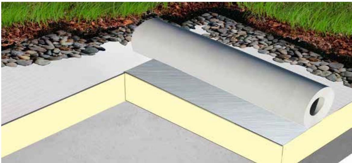
Покрівельні мембрани KÖSTER TPO можна вільно укладати під зелені зони, за умови, якщо подальша конструкція даху служить баластом і таким чином захищає від засмоктування вітру.
